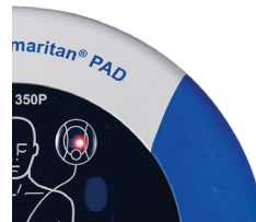
Obrázek 9. Blikající červené světlo a/nebo pípání; viz Odstraňování závad v příloze B.
