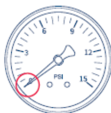
Ujistěte se, že tlakoměr ukazuje 0 kPa
